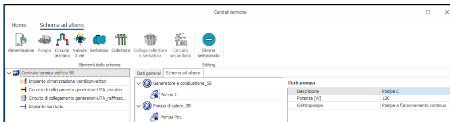
Figura 51: Inserimento Pompa Primaria della PdC della Caldaia
